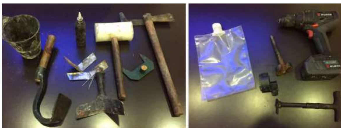
Figura 1. Herramientas utilizadas en el ensayo. Pica tradicional -izquierda; Pica mecanizada -derecha
