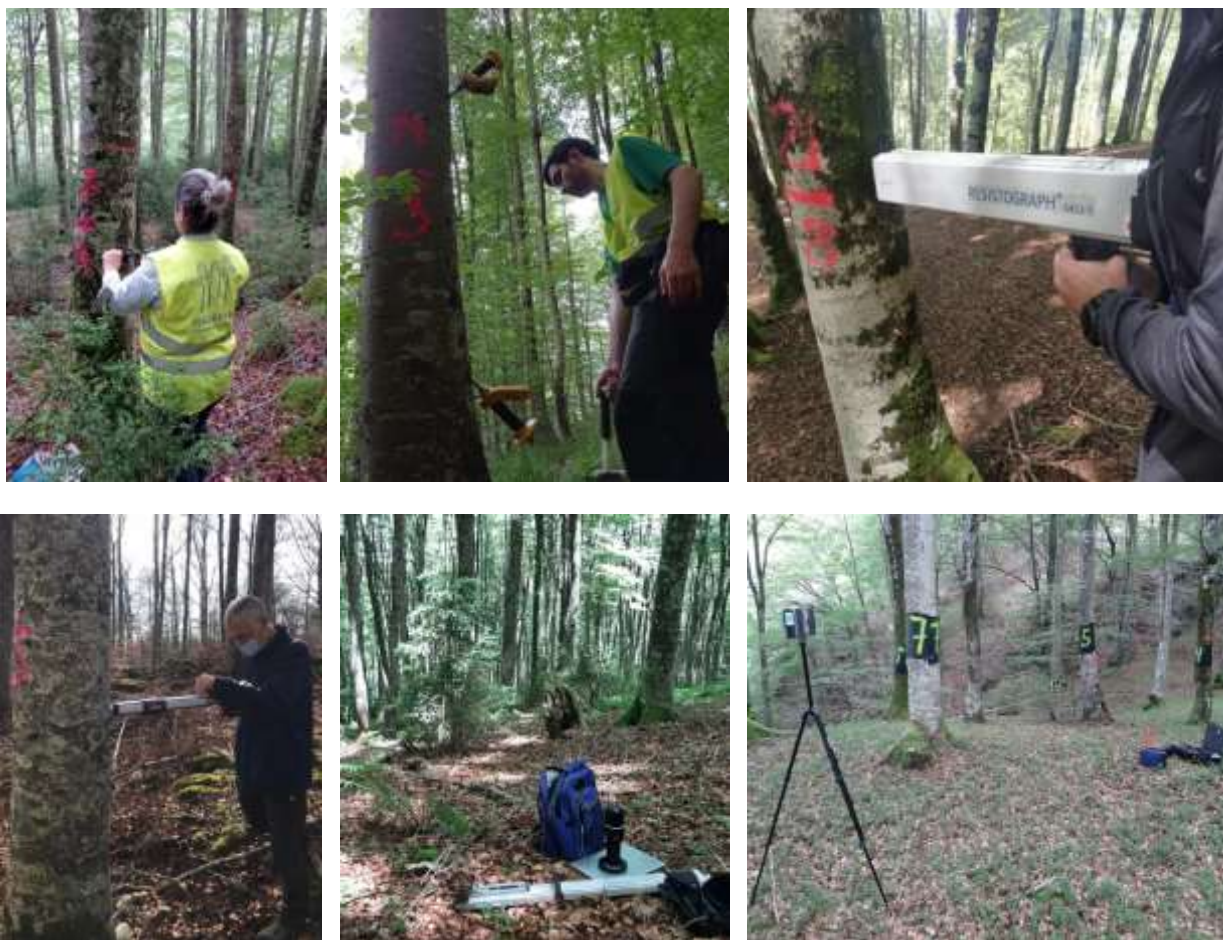
Figura 3. Metodologías utilizadas en campo para caracterización de las masas: a) Extracción de cores con barrena de Pressler, b) Estimación de velocidad de desplazamiento con ST300 (fibre-gen) c) Obtención de perfil resistográfico mediante el equipo 4450S (Rinntech), d) Obtención de perfil resistográfico mediante el equipo modelo IML-RESI PD500, e) láser escáner de mano cerca del centro de la parcela, f) láser escáner fijo en centro de la parcela. Las hayas muestreadas aparecen numeradas con el fin de facilitar su posicionamiento en los modelos fotogramétricos
