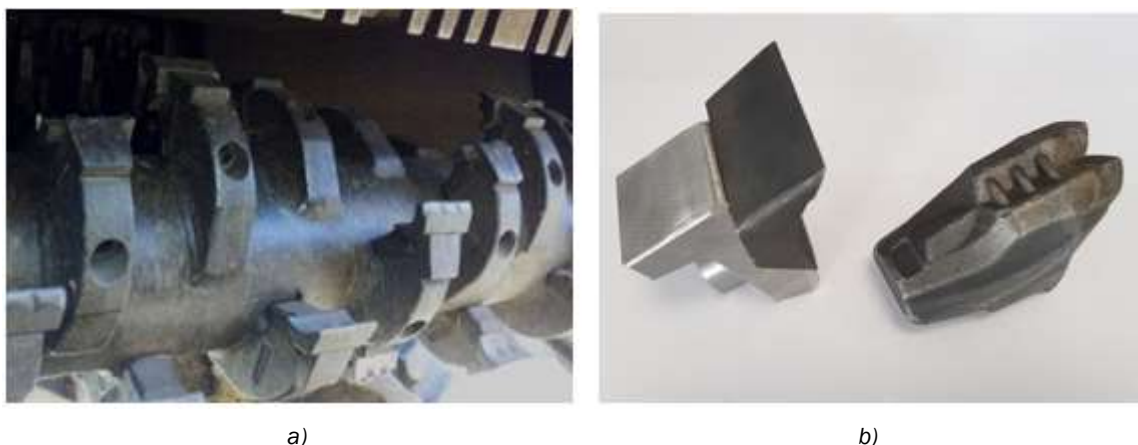
Figura 3. (a) Rotor de corte de la desbrozadora-empacadora; (b) Útiles de corte: cuchillas (izquierda) y martillos fijos (derecha)
