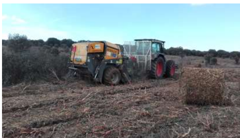
Figura 2. Desbrozadora-empacadora Biobaler WB55 trabajando sobre matorral de jara ( Cistus laurifolius L.)
