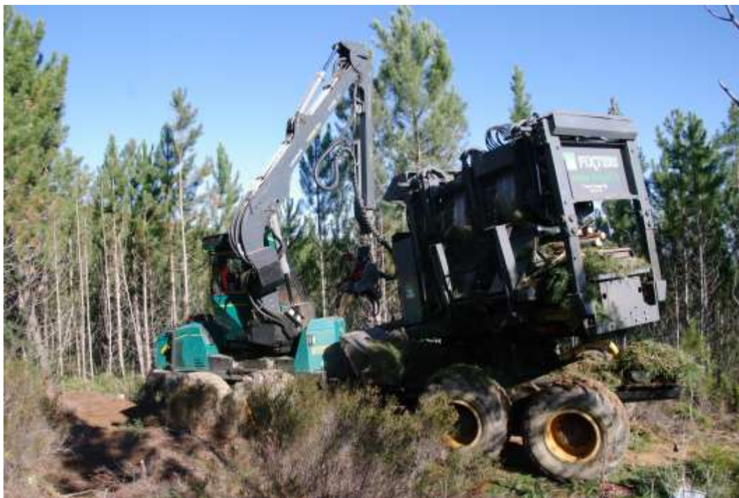
Figura 1. Taladora-empacadora de árboles completos Fixteri FX-15a durante los ensayos.
