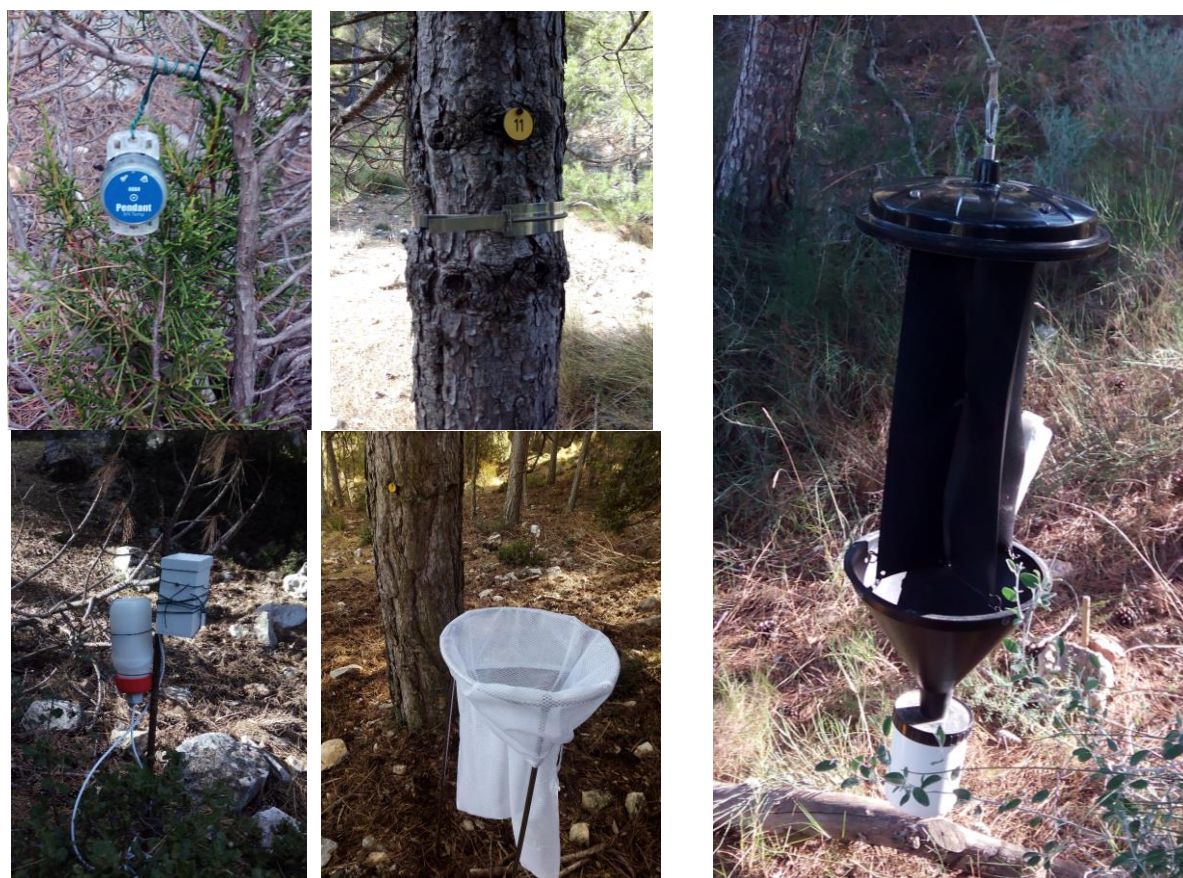
Figura 2. Instrumental actualmente utilizado en las ESFP. Arriba izquierda: registrador HOB0 pendant MX con conexión bluetooth. Arriba centro: etiqueta identificativa y dendrómetro de banda instalados. Abajo izquierda: Pluviometro de cuchara Rain-o-m.100, conectado a registrador HOB0 pendant event UA-003-64 protegido en caja estanca. Abajo centro: colector de desfronde. Derecha: trampa Crossstrap cebada con etanol, alfa-pineno, ipsenol, ipsdienol y cis-vervenol.
