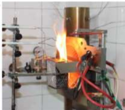
Figura 3. Ensayo en el calorímetro de pérdida de masa (MLC). Configuración vertical (Espinosa et al., 2020).
