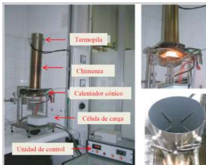
Figura 2. Calorímetro de pérdida de masa con termopila utilizado en los ensayos con muestras de Pinus pinea .
