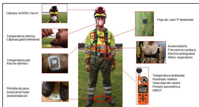
Figura 1. PEEIF equipado con buzo sensorizado previo a salida a incendio. Detalle de sensores utilizados en esta investigación.
