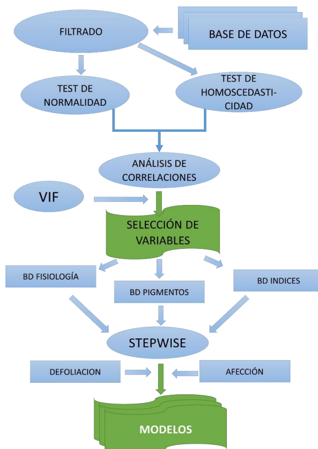
Figura 2. Diagrama de flujo usado en la generación de los modelos relacionales de afección y defoliación. Los cuadrados azules representan inputs (introducción de datos), los círculos azules los procesos y las banderas verdes los productos (intermedios y finales).
