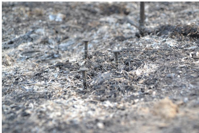
Figura 2. Testigos metálicos para la evaluación de la consunción del combustible superficial tras una quema prescrita.
