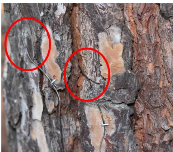
Figura 3. Localización de los termopares en la superficie de la corteza y a nivel del cambium para la monitorización de las temperaturas en el arbolado durante las quemas experimentales (Fuente: ESPINOSA et al. 2020).
