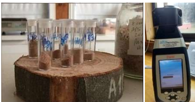
Figura 3. Vista de polvo de astilla obtenido a partir de los tarugos y estimación de densidad básica mediante equipo de espectroscopía NIR.
