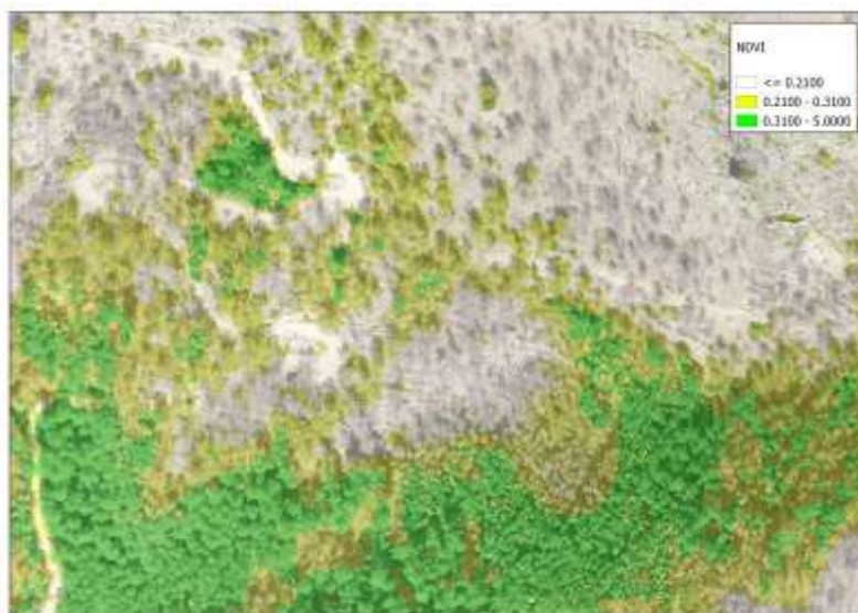
Figura 5. Rangos de valores de NDVI para el vuelo del 09 de marzo de 2017. En color transparente se indica las zonas con valor de NDVI < 0,21 ; en color amarillo las zonas con NDVI con valores entre 0,21 y 0,31; en color verde los NDVI > 0,31 .
