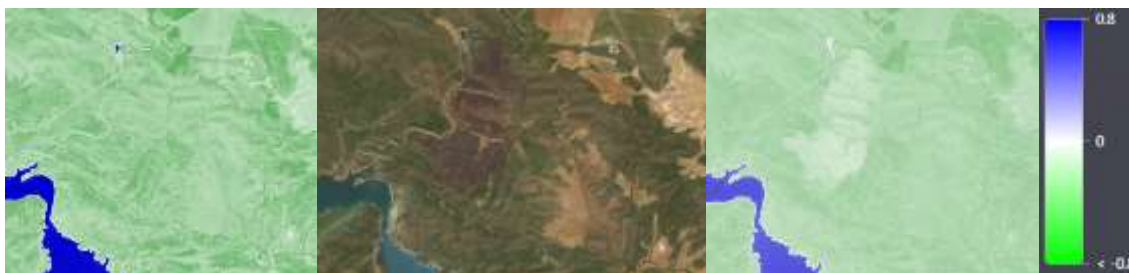
Figura 5. Izquierda: imagen NDWI del 29 de julio de 2020, 1 día antes del inicio de incendio en el término municipal de Férez (Albacete). Centro: imagen en verdadero color del día 1 de agosto de 2020. Se observa la marca del incendio. Derecha: imagen NDWI del día 1 de agosto. Se observa el descenso de la lámina de agua señalada con flecha.
