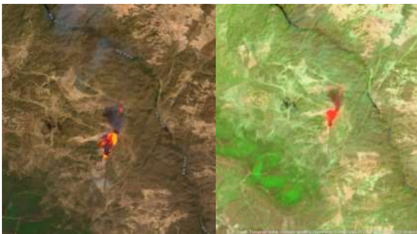
Figura 8. Izquierda: Imagen de la composición Wildfire ( https://pierre-markuse.net/2018/04/30/visualizing-wildfires-burn-scars-sentinel-hub-eo-browser/ ). Derecha: Imagen del SWIR, las dos del día 30 de julio de 2020. Se puede observar un foco secundario a unos 445 metros del frente principal.
