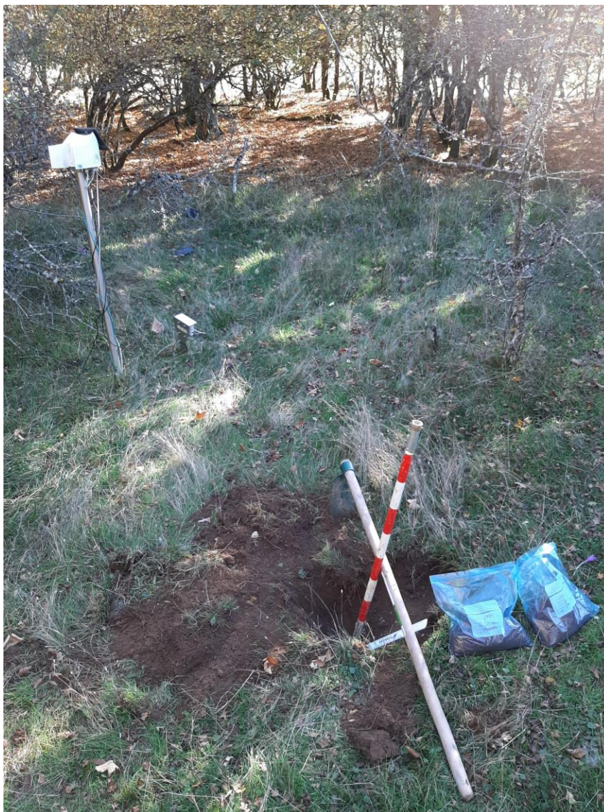
Figura 9. Instalación de los sensores en la finca de Iturrieta (Álava), junto a la calicata realizada.
