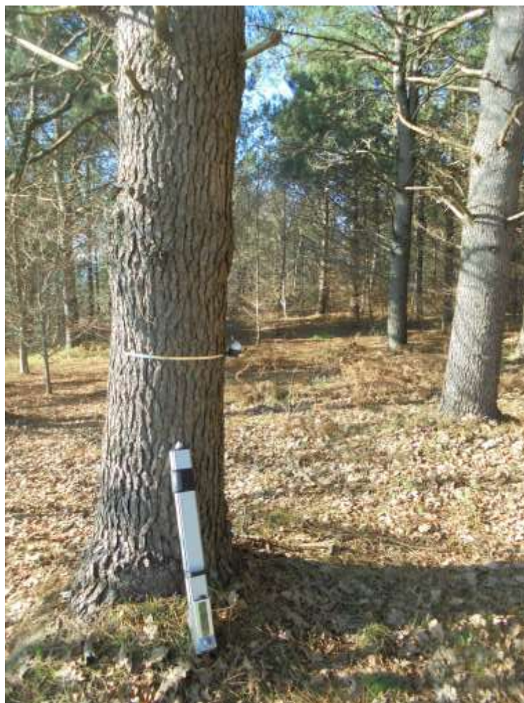
Figura 10. Dendrómetro instalado en el pino pináster de Ganguren (Bizkaia), junto al resistógrafo.
