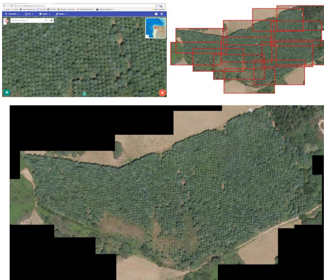
Figura 6. En sentido horario y empezando en la parte superior izquierda: ortofotografía parcial del monte en IBERPIX, a nivel máximo de ampliación; mosaico de ortofotografías; ortofotografía final por combinación de las anteriores.
