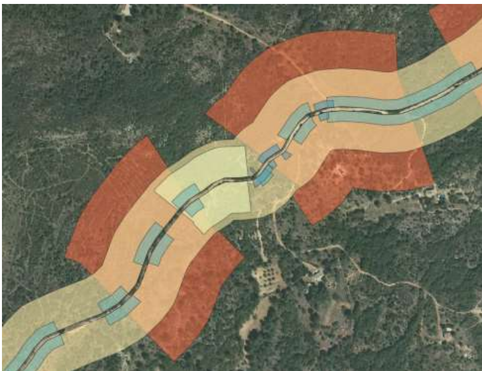
Figura 6 Diferentes anchuras del área cortafuego en función de las DSS_Fp que han intersectado con el borde de la pista forestal.
