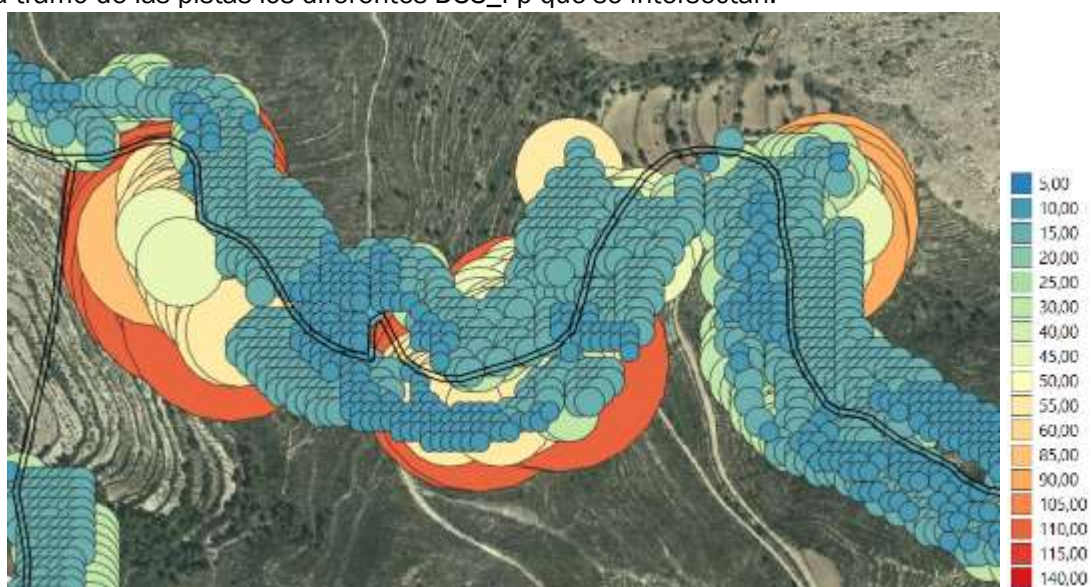
Figura 5 Buffer de la DSS_Fp (m) para cada uno de los centroides del modelo de combustible. En negro se observan las líneas de los bordes de las pistas forestales.
