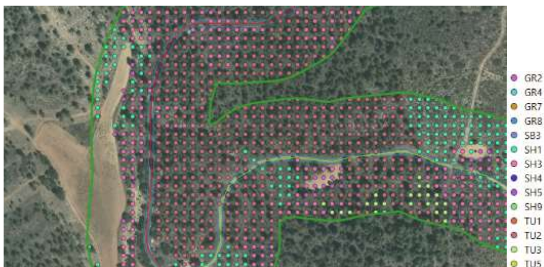
Figura 4 Imagen de una zona en la que se observan los ejes de las AACC (líneas roja y verde claro), el ancho de la pista forestal (en azul), el ancho del buffer de 65 m (verde oscuro) y los puntos de los centroides de cada píxel del modelo de combustible (colores según modelos).
