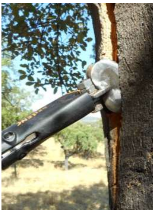
Figura 8. Operación de ahuecar realizada con las tenazas eléctricas de pértiga, con las primeras lengüetas fabricadas.
