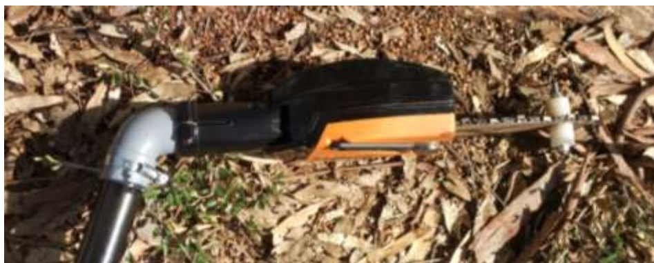
Figura 1. Detalle del cabezal de la sierra de pértiga Selion T150-200 modificada previamente por el ICMC.
