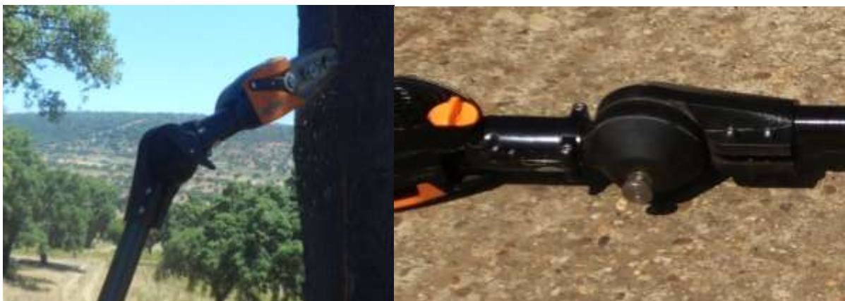
Figura 2. Detalle del cabezal de la sierra de pertiga Selion T150-200 modificada con la nueva rótula.
