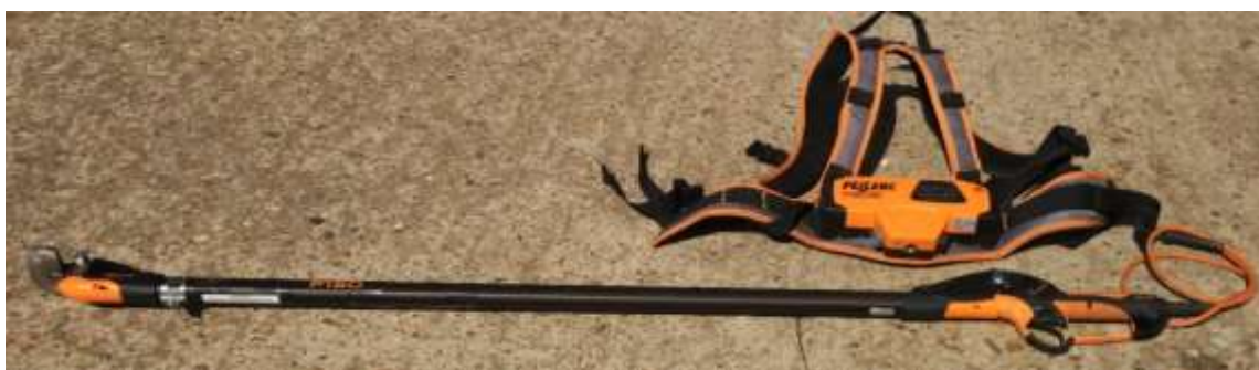
Figura 9. Tenazas corcheras de pértiga basadas en las tijeras Prunion T150.
