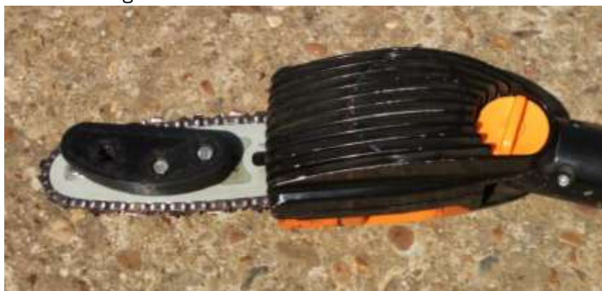
Figura 3. Motosierra Selion T150-200. Detalle del patín regulable para limitar la profundidad de corte.
