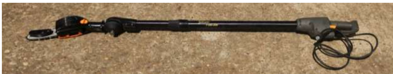
Figura 7. Motosierra Selion T150-200 con las modificaciones realizadas para rayar en altura.
