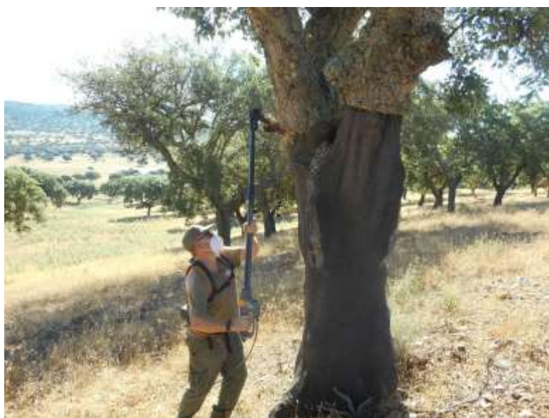
Figura 5. Motosierra Selion T150-200 con las modificaciones realizadas para rayar en altura, durante la operación de trazar.
