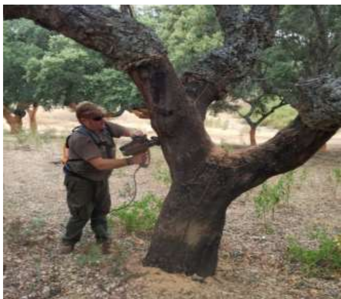
Figura 1. Operación de abrir con la máquina COVELESS 3C18
