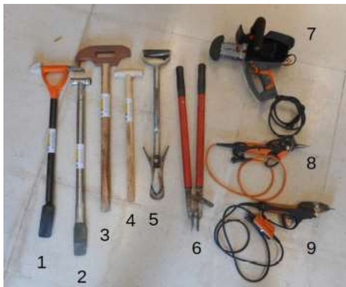
Figura 2: Herramientas usadas en el proyecto GOSUBER. (1) y (2) Palancas tecnológicas de descortche, (3) y (4) Mijuros de madera, (5) Mijuro metálico, (6) Tenazas corcheras manuales, (7) máquina COVELESS 3C18, (8) Tenazas eléctricas Prunion y (9) Tenazas eléctricas Treelion.
