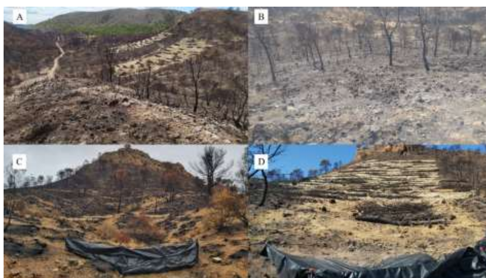
Figura 3. (A) Vista general de las microcuencas; (B) Microcuenca control; (C) Microcuenca con Easy-Barriers® y trampa de sedimento; (D) Microcuenca con muclh y acordonado y trampa.
