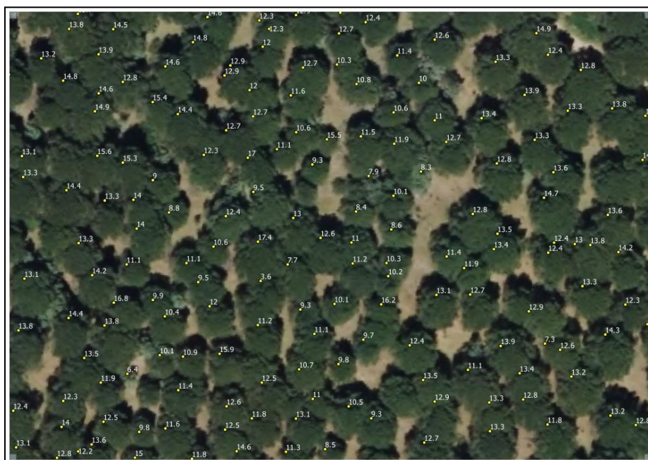
Figura 2. Valores de altura máxima (m) de los pies de pino piñonero del monte Tudía y su Faldas mediante la localización de los máximos a partir de la nube de puntos LiDAR PNOA del 2018
